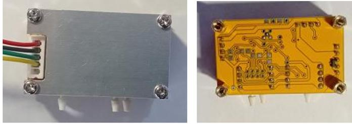
Delta Tech 公司设计开发的大气数据模块，即 ADM 高度空速传感器模块-数字空速计，为飞行器提供多种重要的飞行参数，例如飞行高度 (Hp) 和空速 (CAS)，静压 (Ps)，动压 (Qc)。ADM800 系列大气数据模块，可以连接各种空速管，包括不加热空速管和加热型空速管来测量飞行器的空速和气压高度，特别适合 UAV 等飞行器的 OEM 应用。
