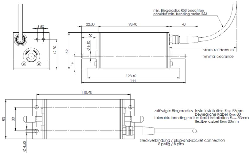
安装孔螺钉或螺栓：M4。
