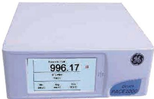
高精度Druck压力指示仪，专为测试工作台、台式及面板安装式的压力校验、测试和监测等应用而设计。
