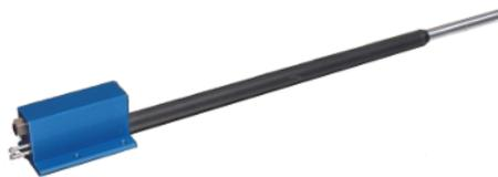
瑞士史密泰克（Simtec AG）公司的HPS-1是一种质量轻的全-静压空速管。它集成了可调控温度的加热器和排水系统，可以防止冰和水汽聚集。
