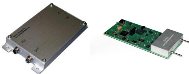
瑞士史密泰克公司(Simtec AG)微型大气数据计算机为飞行器提供多种有价值的飞行参数,例如飞行高度(Hp)和速度(CAS和TAS),静压(Ps),动压(Qc)和静温(OAT)。PSS-8 ADC和PSS-8M ADC可以与多种空速管相连接,组成大气数据系统。
