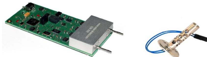
瑞士史密泰克公司(Simtec AG)微型大气数据计算机为飞行器提供多种有价值的飞行参数,例如飞行高度(Hp)和速度(CAS和TAS),静压(Ps),动压(Qc)和静温(OAT)。PSS-8 ADC和PSS-8M ADC可以与多种空速管相连接,组成大气数据系统。
